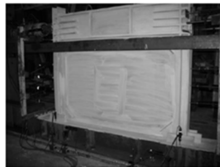
شکل (۲): نمونه آزمایشگاهی دیوار برشی فولادی لاغر بدون سخت کننده صبوری قمی و اسعد سجادی [۲۶]
