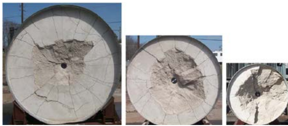
شکل (۶): ناحیه چاله‌ای به وجود آمده در آزمون برخورد [۲۱]
