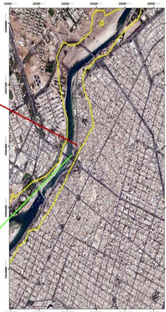
شکل (۴): نمایی از انطباق دو نقطه بحرانی در سیلاب ۱۳۹۸ بر نقشه پهنه‌بندی سیلاب با دوره بازگشت ۲۵ ساله رودخانه دز
