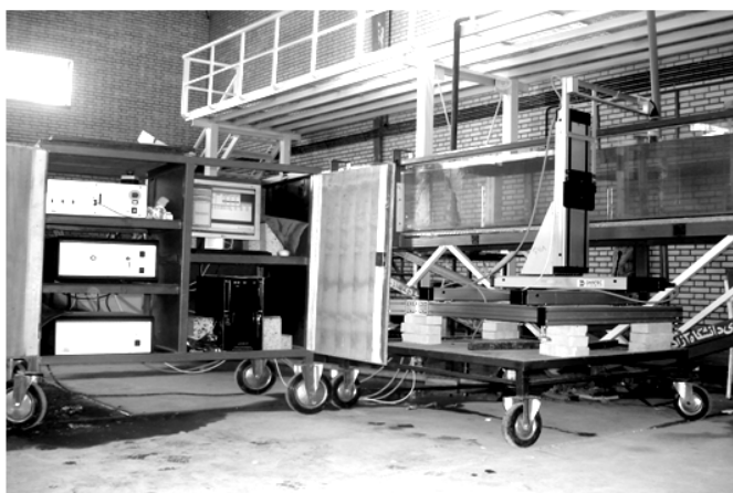
شکل ۴- اندازه گیری سرعت بدنه جریان غلیظ توسط دستگاه لیزر داپلر
