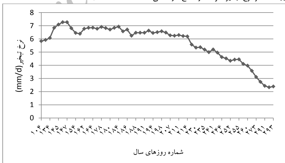
شکل ۷- تغییرات نرخ تبخیر روزانه از سطح دریاچه ارومیه طی روزهای بدون ابر در سال ۲۰۱۰
