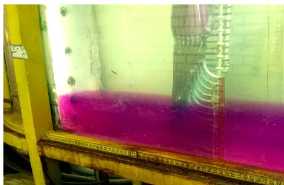
شکل ۵- نمونه‌ای از جریان غلیظ ایجاد شده پشت دریچه در ارتفاع ۹ سانتی‌متری
