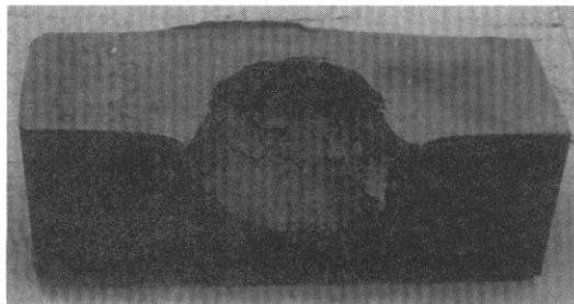
شکل ۷ - نحوه نفوذ پرتابه با لاینر کروی.
