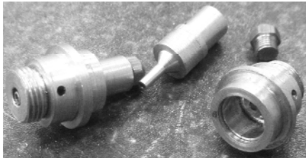
شکل ۹: انژکتور گریز از مرکز ساخته شده از برنج شامل درپوش، انژکتور داخلی و انژکتور خارجی.
