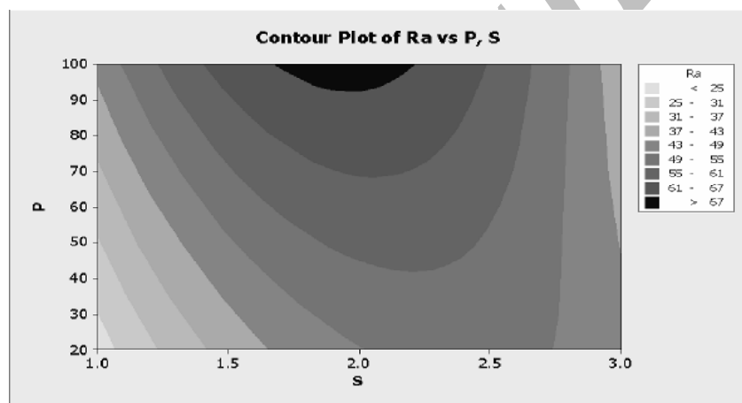
شکل (۶): نمودار کانتوری مربوط به تأثیر دو فاکتور نوع ذره و فشار بر زبری سطح.
