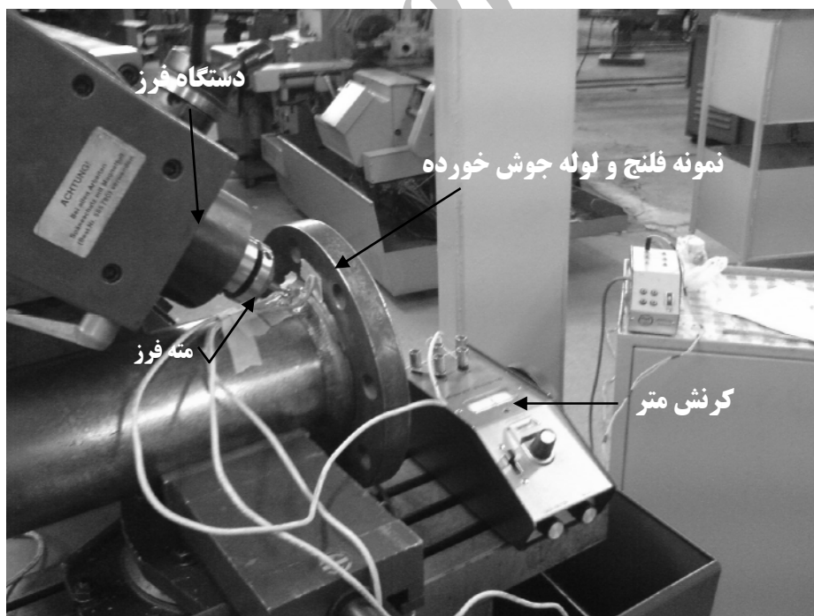
شکل (۴): اندازه‌گیری تنش پسماند در روی گرده جوش اول با استفاده از روش سوراخکاری و کرنش سنج.
