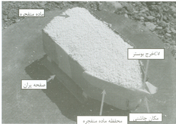
شکل (۴): چیدمان قطعات در انجام جوشکاری انفجاری.
