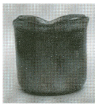
شکل (۱۷): نمونه شکل داده شده با فشار بیشینه ۳/۳، (الف) تجربی، (ب) شبیه سازی.
