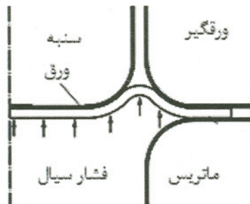
شکل (۱۳): حالت پیش بشکه ای ایجاد شده با استفاده از مسیر فشار شکل ۱۲-ب.
