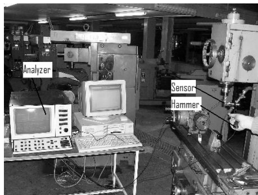
شکل (۳): تنظیم تجربی آزمایش مودال.
