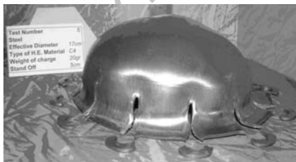
شکل (۷): نتیجه آزمایش پنجم و اثر قرارگیری ۲۰ گرم ماده منفجره C-4 در فاصله ۵ cm از صفحه.
