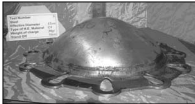
شکل (۵): نتیجه آزمایش سوم و اثر قرارگیری ۳۰ گرم ماده منفجره C-4 در فاصله ۱۰ cm از صفحه.
