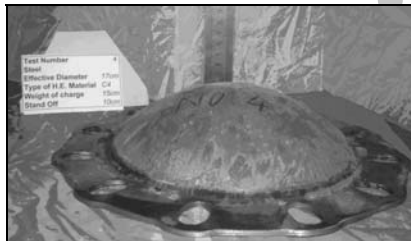
شکل (۶): نتیجه آزمایش چهارم و اثر قرارگیری ۱۵ گرم ماده منفجره C-4 در فاصله ۱۰ cm از صفحه.
