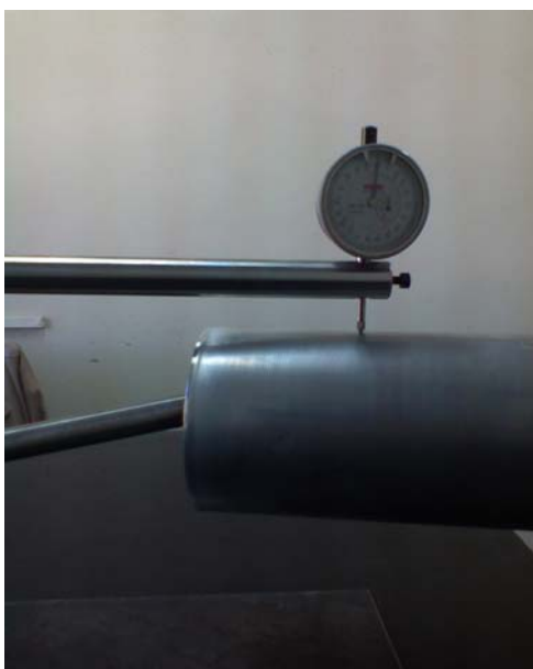
شکل (۱۰): نحوه اندازه‌گیری ضخامت در نقاط مختلف قطعه با استفاده از دستگاه نشان داده شده در شکل ۹.
