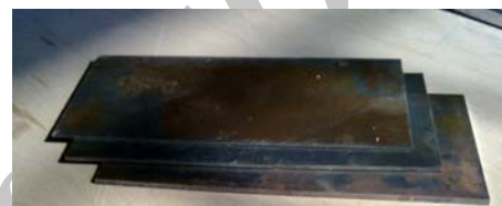
شکل (۷): نمونه‌های ورق‌های فولادی قبل از فرآیند خمش بر روی بستر لاستیکی.
