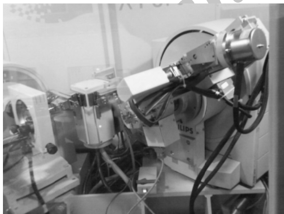
شکل (۸): دستگاه مورد استفاده جهت اندازه‌گیری تنش پسماند به روش استاندارد پراش اشعه ایکس.
