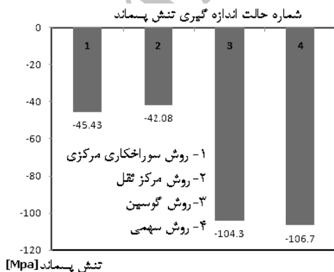
شکل (۱۱): مقایسه تنش‌های اندازه‌گیری شده به روش‌های سوراخ‌کاری و پراش اشعه ایکس.
