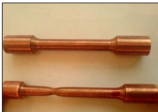
شکل (۵): نمایی از نمونه مسی قبل و پس از آزمایش.
