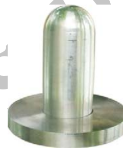
شکل (۳): پوسته استوانه‌ای با درپوش کروی تحت اثر شرایط مرزی یک‌سرگردار.
