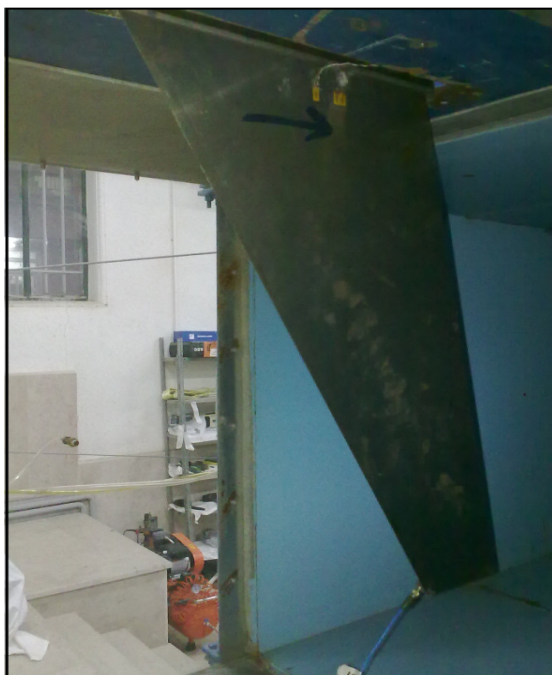
شکل (۴): مدل نصب شده به دیواره‌ی صلب، جهت انجام تست مودال.
