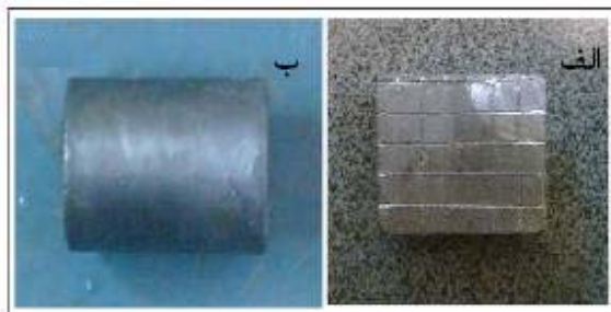
شکل (۴): بیلت های اولیه سربی الف) بیلت دو تکه، ب) بیلت یک تکه.
