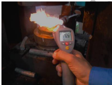
شکل (۱۳): عملیات پیش‌گرم قالب‌ها و اندازه‌گیری دمای قالب‌ها با حرارت‌سنج لیزری.
