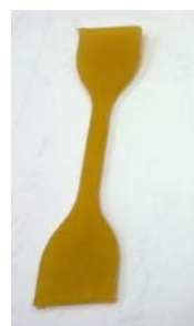
شکل (۱۳): تصویر نمونه تست کشش ماده لاستیکی بستر.
