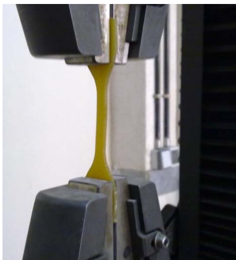
شکل (۱۴): نمونه تست کشش لاستیکی در حال تست بر روی دستگاه تست کشش INSTRON-5500R.
