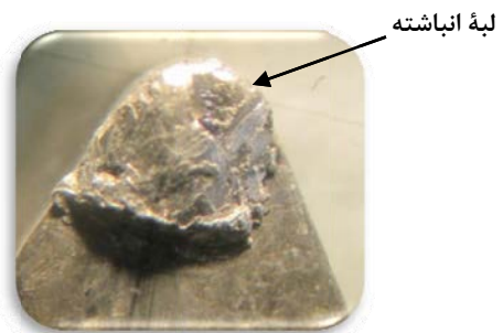
شکل (۸): تشکیل لبه انباشته بر روی ابزار سرعت ماشین کاری 60 \text{ m/min} ، نرخ پیشروی 0.08 \text{ mm/rev} و عمق تراش 0.8 \text{ mm} .
