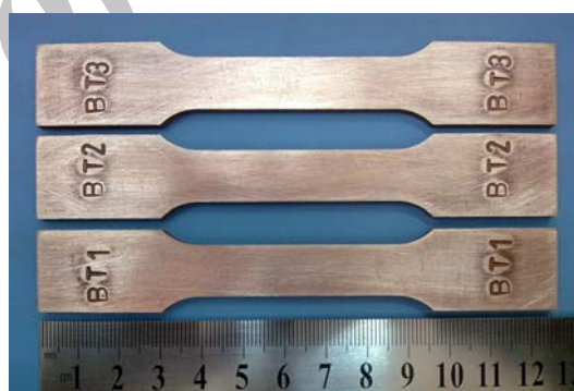
شکل (۹): نمونه‌های کشش تهیه شده از مس پایه.
