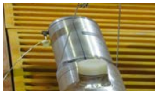
شکل (۱): نحوه نصب سنسورهای شتابسنج بر روی نمونه.
