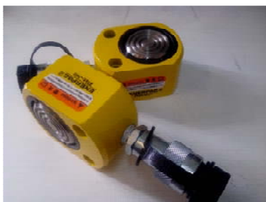
شکل (۱۵): جک هیدرولیک ۲۰ تن مورد استفاده در ساخت ماشین هیدروفرمینگ در پژوهشگاه سازمان صنایع هوایی.
