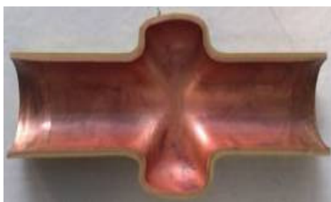
شکل (۱۱): آزمایش تجربی هیدروفرمینگ لوله دولایه [۶].
