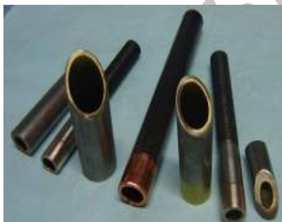
شکل (۲): انواع لوله‌های دو لایه [۳].
