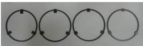
شکل (۸): فیکسچر- فاصله‌اندازهای ساخته شده برای نسبت‌های کشش مختلف.
