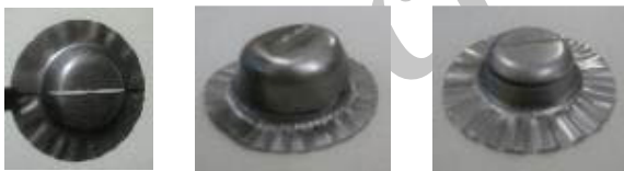
شکل (۱۳): انواع پارگی در شکل‌دهی هیدرومکانیکی لوح‌های ترکیبی: الف) دیواره و شعاع سر سنبه در بخش نازک‌تر لوح، ب) دیواره و شعاع رینگ کشش در بخش نازک‌تر لوح و ج) کف و ناحیه جوش.
