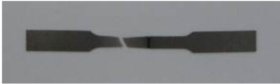
شکل (۱۱): وقوع پارگی در بخش نازک‌تر نمونه‌های آزمون کشش تک محوره با جوش عرضی.
