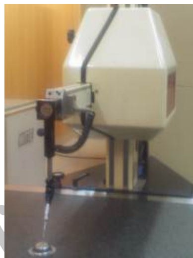
شکل (۱۴): بررسی مسیر خط جوش توسط دستگاه CMM.
