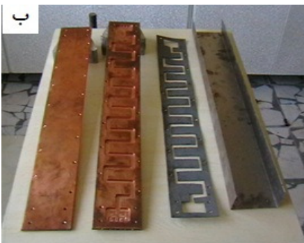
شکل (۱): (الف) دستگاه ریخته‌گری سطح شیب‌دار مورد استفاده در این تحقیق و (ب) مسیر جریان آب برای خنک‌کاری سطح شیب‌دار مسی.
