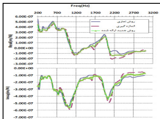
شکل (۱۵): مقایسه پاسخ دینامیکی حاصل از اندازه‌گیری مودال در نقطه ۴ (نقطه انتهای هولدر) و مدل جدید ارائه شده برای کوپلینگ هولدر به اسپیندل.
