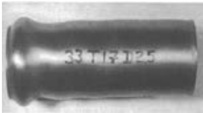
شکل (۳): کمانش پلاستیکی دینامیکی یک لوله دایروی از جنس آلومینیوم 6061 T6 تحت بار ضربه‌ای محوری [۱].
