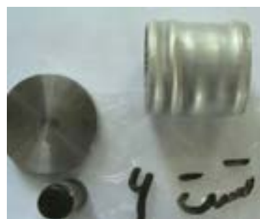
شکل (۱۵): ایجاد کماتش پلاستیکی دینامیکی در لوله آلومینیومی در آزمون شماره (۶) با سرعت ضربه زننده
