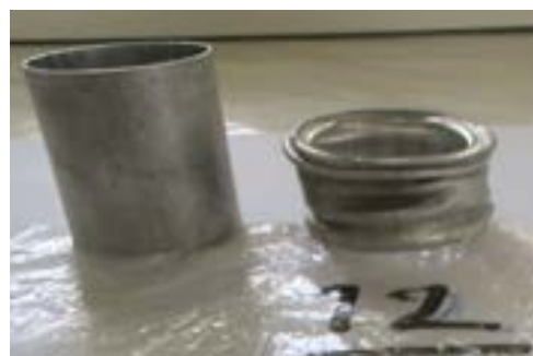
شکل (۲۰): نحوه لهیدگی لوله آلومینیومی در آزمون شماره (۱۲) [۱۷].
