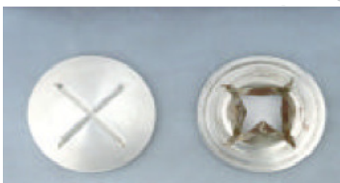
شکل (۱۰): نمای دیافراگم در قبل و بعد از پارگی [۱۹].
