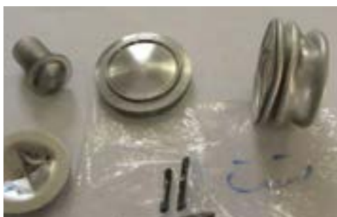
شکل (۲۴): تغییر شکل بافر و تغییر قطر محل تماس پرتابه از آزمون تجربی در آزمون شماره (۱۱) [۱۷].
