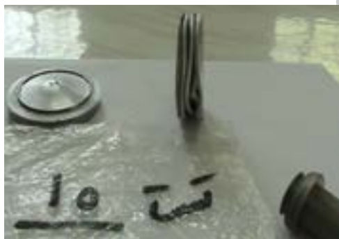
شکل (۲۳): تغییر شکل بافر و تغییر قطر محل تماس پرتابه از آزمون تجربی در آزمون شماره (۱۰) [۱۷].
