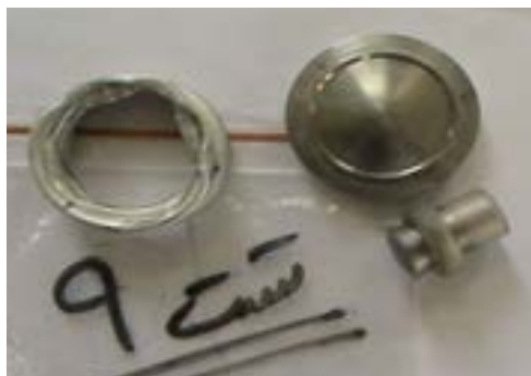
شکل (۲۲): تغییر شکل بافر و تغییر قطر محل تماس پرتابه از آزمون تجربی در آزمون شماره (۹) [۱۷].
