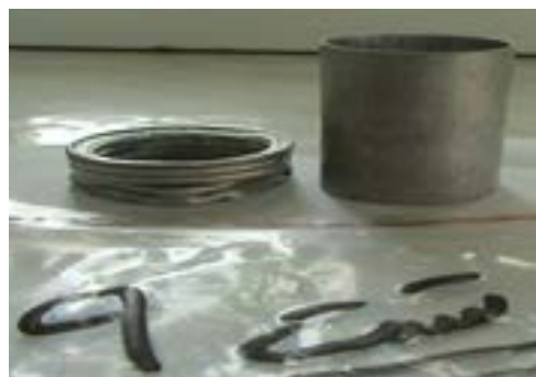
شکل (۱۷): نحوه لهیدگی لوله آلومینیومی در آزمون شماره (۹) [۱۷].
