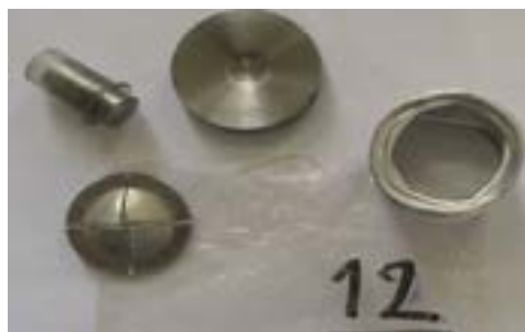
شکل (۲۵): تغییر شکل بافر و تغییر قطر محل تماس پرتابه از آزمون تجربی در آزمون شماره (۱۲) [۱۷].
