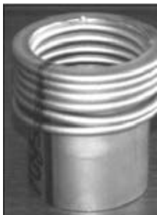
شکل (۱): لهیدگی پیش‌رونده دینامیکی یک لوله استوانه‌ای جدار نازک از جنس آلومینیوم 6060 T5 [۲].
