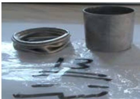
شکل (۲۱): نحوه لهیدگی لوله آلومینیومی در آزمون شماره (۱۳) [۱۷].
