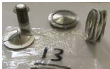
شکل (۲۶): تغییر شکل بافر و تغییر قطر محل تماس پرتابه از آزمون تجربی در آزمون شماره (۱۳) [۱۷].
