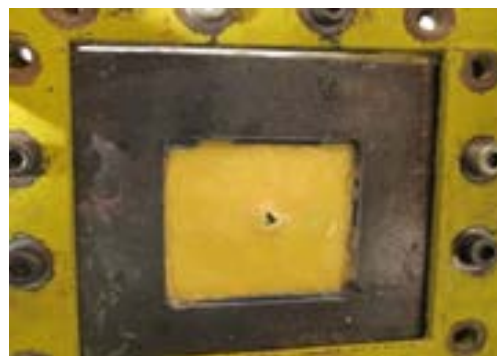
شکل (۱۲): سطح جلوی پارچه آغشته به STF تحت ضربه.
