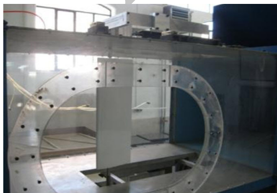
شکل (۱۱): نحوه قرارگیری بال در تونل باد.
