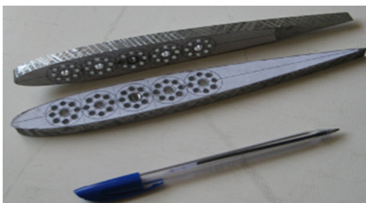
شکل (۲): ریب‌های آلومینیومی با مقطع NACA۰۰۱۲.
