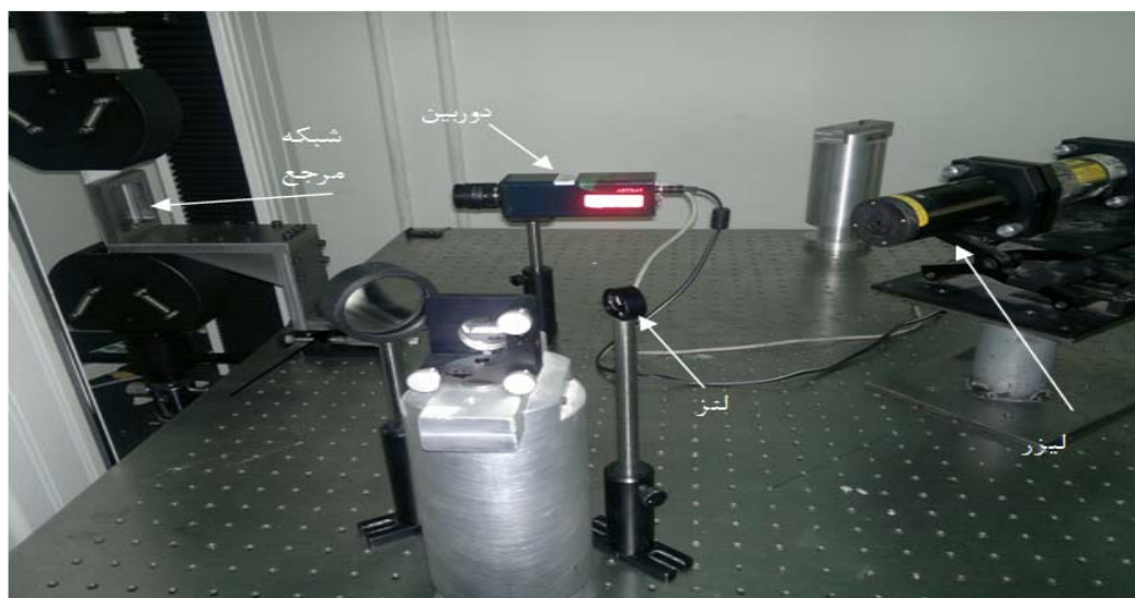
شکل (۴): چیدمان روش موری سایه ای با جابه جایی فاز فیزیکی.
