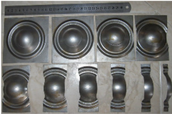
شکل (۲): نمونه‌های کشیده شده از جنس فولاد St14 با ضخامت ۰/۸ میلی‌متر.
