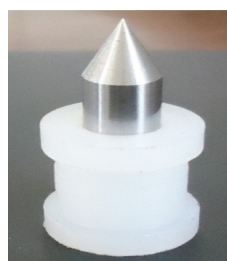
شکل (۴): ابعاد هندسی پرتابه و یک نمونه پرتابه همراه با سابوت مورد استفاده در آزمایش.
