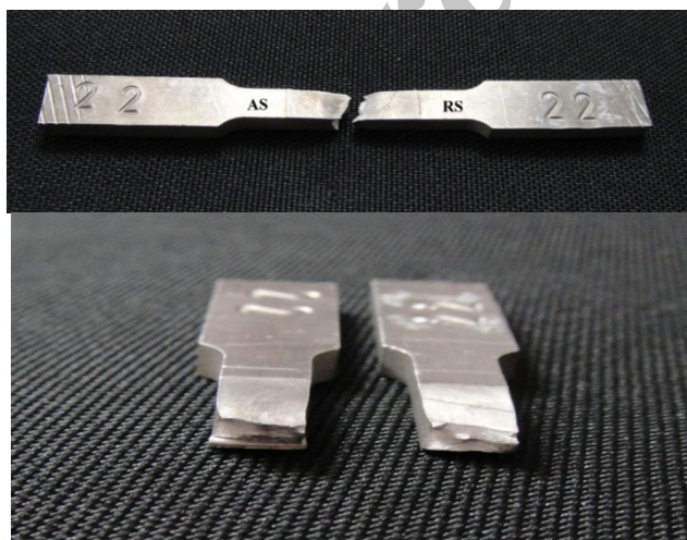
شکل ۸): نمونه شکسته شده آزمون کشش ابزار O،
