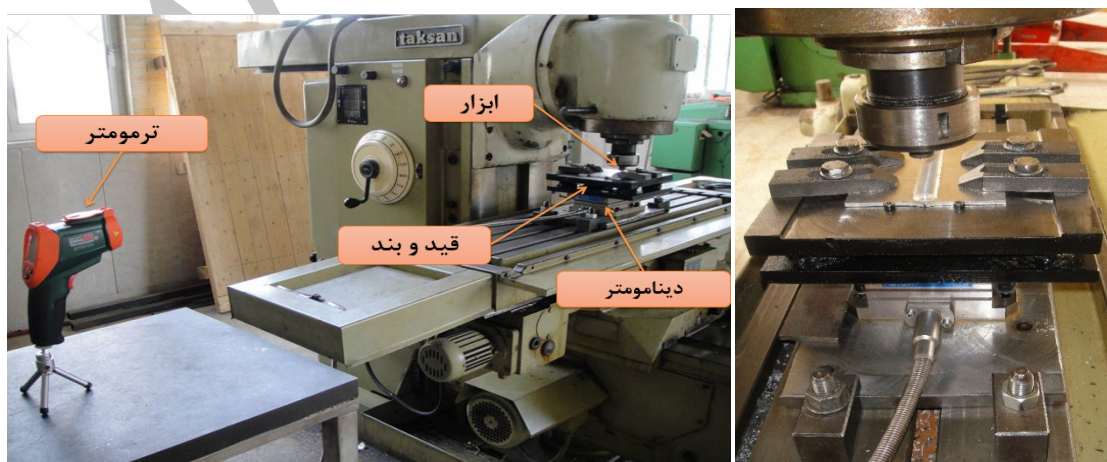
شکل (۲): نمایی از آماده‌سازی فرایند جوشکاری اغتشاشی اصطکاکی.
