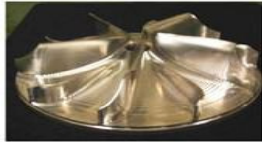
شکل (۲): پروانه ساخته شده با روش تغییر شکل ماشینکاری [۱۰].
