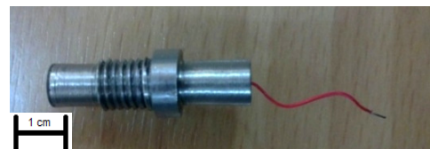
شکل (۵): تصویری از سنسور فشار TFT در محفظه AISI 304 L (شارژ مد).
