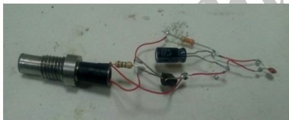
شکل (۷): سنسور پیزوالکتریک به همراه مدار کاهنده امپدانس و مدار تقویت کننده.
