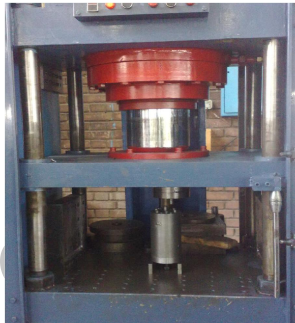
شکل (۴): پرس و قالب مورد استفاده در انجام آزمایش‌ها.
