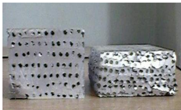
شکل (۱۰): نمونه‌ای با نسبت ارتفاع به عرض 0/8 پس از بارگذاری
