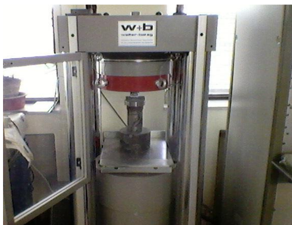
شکل (۳): دستگاه آزمون فشار بتن مورد استفاده جهت آزمایش نمونه‌ها
