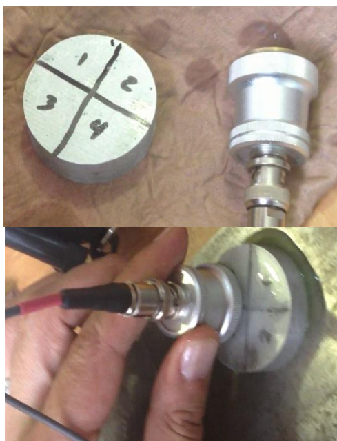
شکل (۱۵): نحوه اندازه گیری تخلخل در بخش های مختلف قطعه با روش آلتراسونیک.
