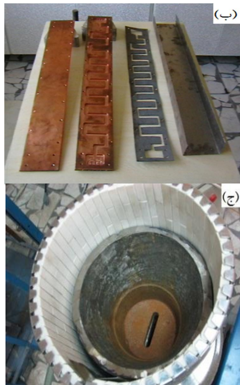
شکل (۱): نمای بخش‌های مختلف دستگاه سطح شیب‌دار، (الف) مجموعه مونتاژ (ب) متعلقات سطح خنک‌کننده (ج) نمای بالایی از المنت و بوتله.
