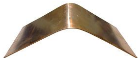
شکل (۹): قطعه شکل داده شده با استفاده از لایه الاستیک از جنس پلی‌یورتان با سختی Shore-A ۸۵.
