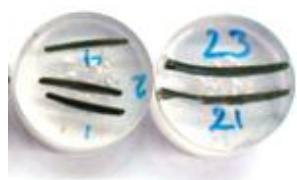
شکل (۴): نمونه‌های متالوگرافی از ایرفویل قطعات فورج شده.
