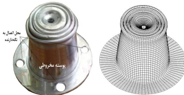
شکل (۳): نتایج شبیه سازی و آزمایشگاهی پوسته مخروطی تحت بارگذاری محوری با بازده لهیدگی ۶۸ درصد.
