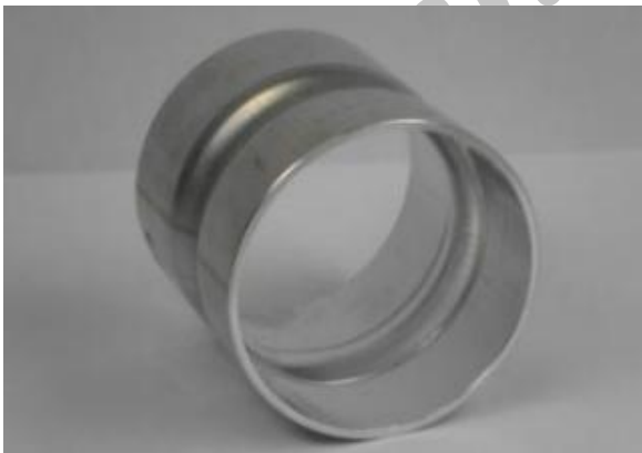
شکل (۲): لوله تغییر شکل یافته با استفاده از این فرایند [۲].
