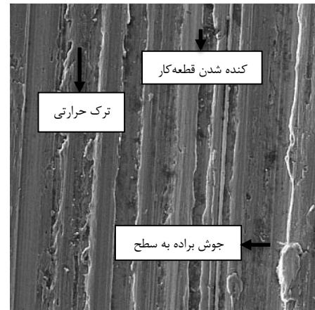
شکل (۱۴): سطح قطعه کار، خنک‌کار: محلول آب- صابون.
