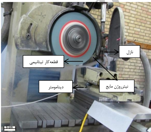
شکل (۱): سنگ زنی با استفاده از نیترژن مایع.
