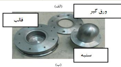
شکل (۱): قالب استاندارد هکر برای بررسی میزان شکل‌پذیری.
