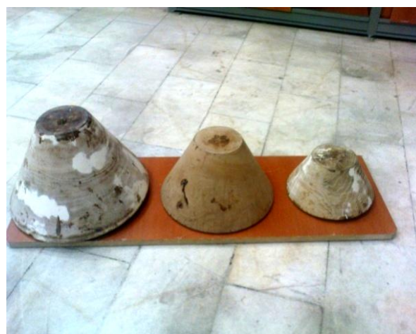
شکل (۱): مدل‌های چوبی مورد استفاده برای ساخت نمونه‌ها.
