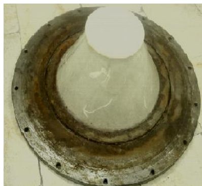
شکل (۴): نمونه مهار شده بر روی کپ بالایی مخزن (شیارها مشخص هستند).
