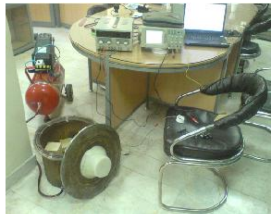
شکل (۶): مجموعه برای بارگذاری دینامیکی خارجی یک نمونه کامپوزیتی آماده شده است.
