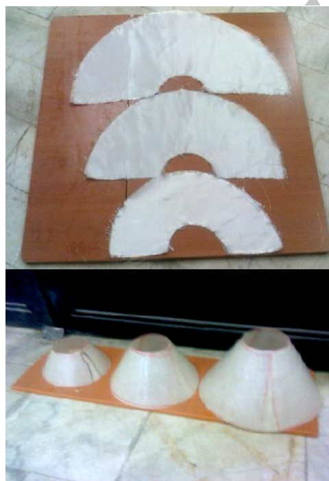
شکل (۲): بالا: پارچه‌های بریده شده و پایین: نمونه‌های کامپوزیتی ساخته شده.
