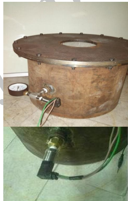
شکل (۵): مخزن ساخته شده (فشارسنج عددی در ابتدا برای کالیبراسیون دستگاه استفاده می‌شود).
