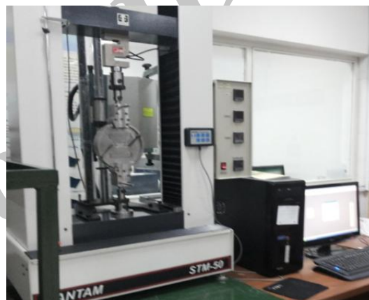
شکل (۱۶): دستگاه تست کشش و فیکسچر جدید نصب شده
